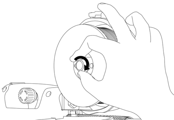
Рис. 7.6. Фиксация катушки с проволокой.
